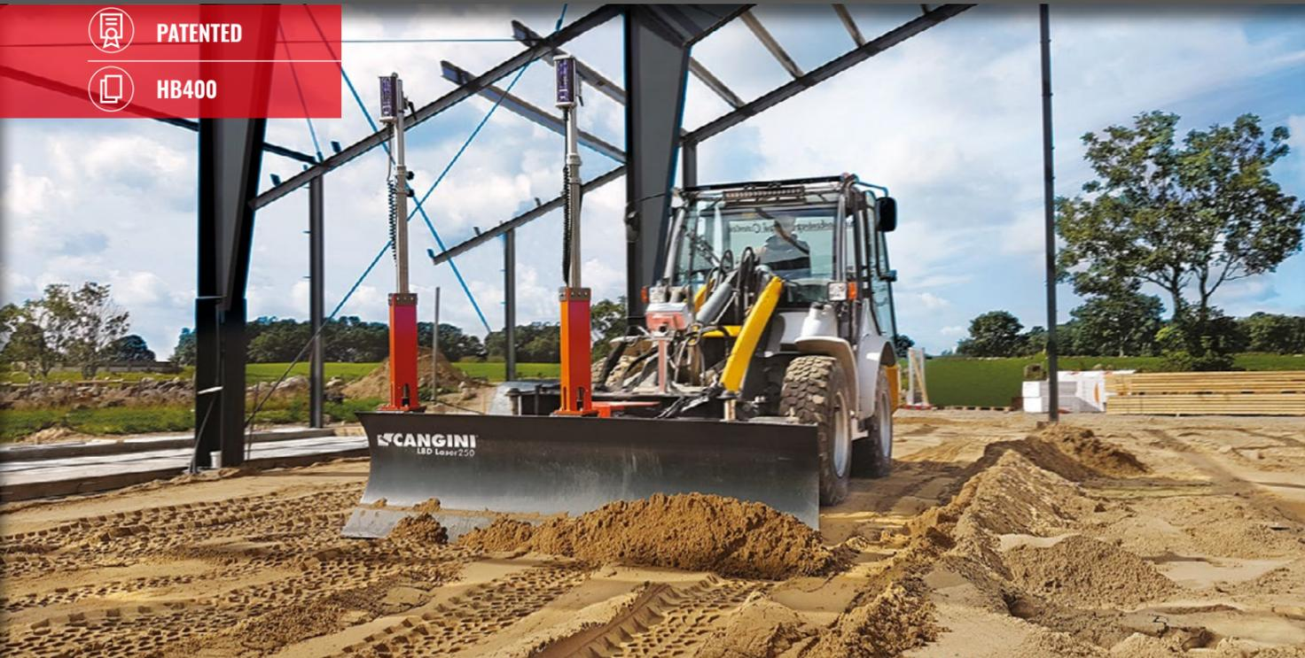
IL SISTEMA DOZER LASER SFRUTTA LE STESS E CARATTERISTICHE DI RESISTENZA E VERSATILITÀ DEL DOZER STANDARD. IN PIÙ OFFRE LA POSSIBILITÀ DI CREARE UN PIANO CONTROLLATO GRAZIE AD UN TRASMETTITORE LASER DOPPIA PENDENZA. IL SEGNALE VIENE RICEVUTO ED ELABORATO DALL'ELETTRONICA A BORDO LAMA CHE AGISCE DIRETTAMENTE SUL DISTRIBUTORE ELETTRO PROPORZIONALE PILOTANDO DIRETTAMENTE LA LAMA.
