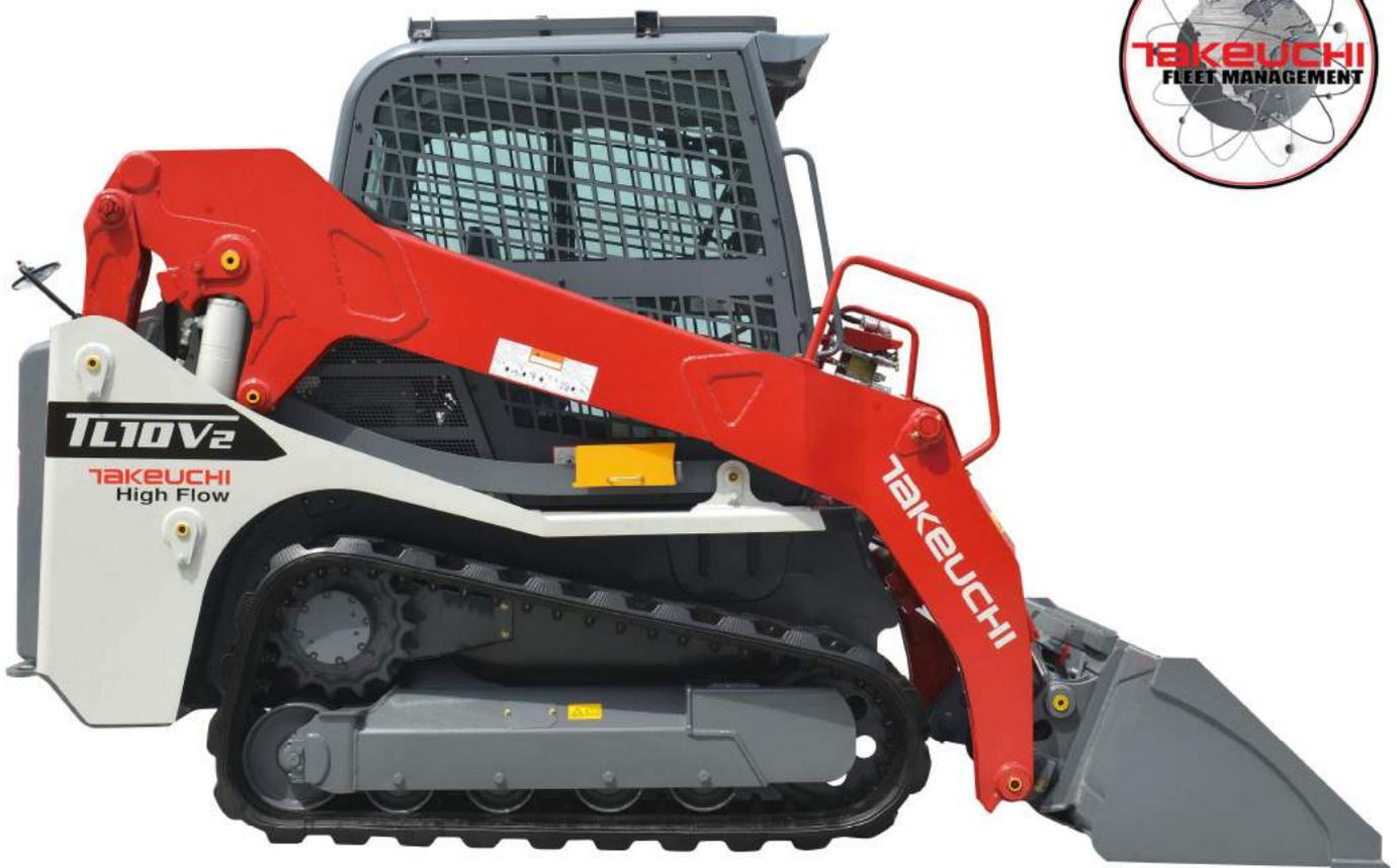
**Macchina ad alta portata d'olio a sollevamento verticale, versatile, adatta sia per il sollevamento carichi che per l'utilizzo con attrezzature a terra.**
