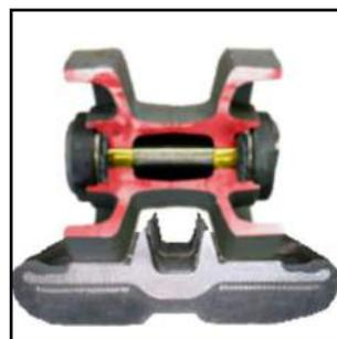
I **motori di traslazione** ad elevato numero di denti con doppia riduzione epicicloidale e parking brake integrato garantiscono una elevata forza di spinta e una elevata quantità di coppia trasmessa a terra. Il motore è montato direttamente sul telaio per garantire una maggior durata, 2 velocità di avanzamento disponibili, è la macchina ideale per il sollevamento carichi e per attrezzature a terra come frese, trincia, ecc..
