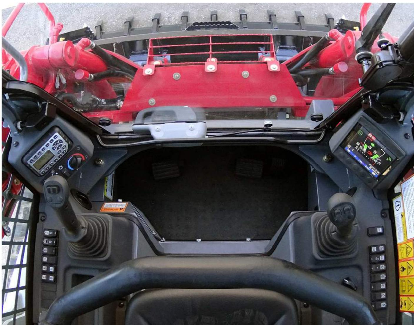
Nuova cabina pressurizzata. Nuovo disegno dello scalino per migliorare la visibilità sulla benna. Nuovo quadro strumenti a colori da 5.7" con telecamera posteriore: studiata per garantire il massimo confort all'operatore.
